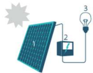
1. Zonnepaneel | 2. Omvormer | 3. Elektrische toestellen
